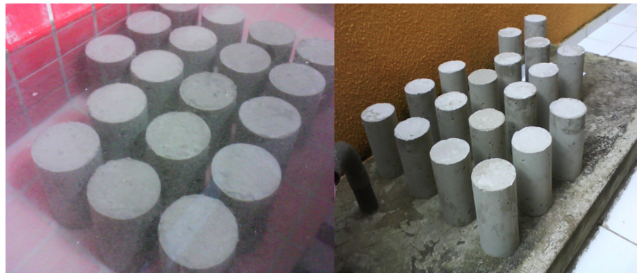
Figura 1 – À esquerda os corpos imersos em câmara úmida, à direita os corpos de prova nas condições de cura externa.
